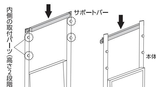
サポートバーが取り付けにくい時は、①本体フレームを少し内側に押すようしながら、②サポートバーを上から押し込むようにしてください。
