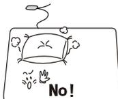
部分的に保温した状態で長時間使用されますと、ヒーター線が劣化しやすくなります。部分的に温度が高くなり、ヒーター線を傷めて発火したり、異常動作をしたりしてやけどをするおそれがあります。(ヒーター線の配線箇所はP.5「正しいご使用方法」をご参照ください。)
