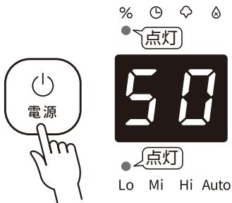
■ センサーが感知した湿度を表示します。(上図は感知した湿度が50%のとき)
