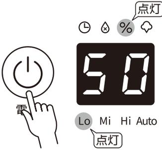
■ センサーが感知した湿度を表示します。(上図は感知した湿度が50%のとき)
