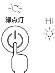
電源ボタンに触れると、加湿量強「Hi」で加湿運転が始まります。このとき電源ランプが緑点灯して、加湿量ランプ「Hi」が点灯します。
