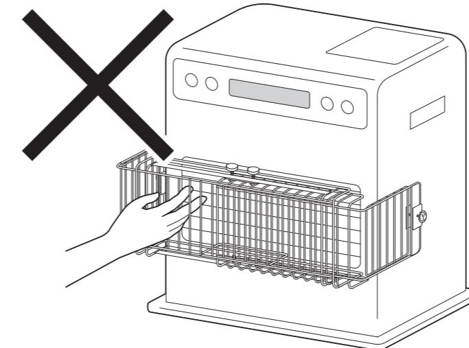
●本体の出っ張りは、必ずヒーター本体の一番下に差し込み、ヒーターのフィンが露出していないか確認してからお使いください。
