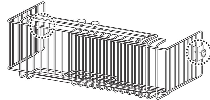
③本体にはめ込み、上部のノブでしっかりと固定してから、左右のノブで更に固定します。
