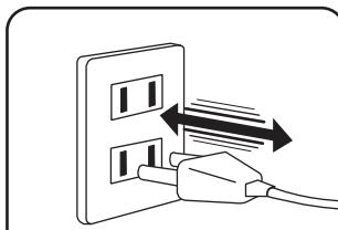
短寿命 コンセントへの抜き差しが頻繁、また電源プラグを斜めに抜き差しする
