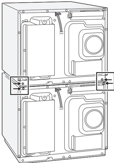
② 外したネジで固定金具をしっかりと締め付けます。
