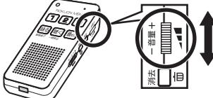
音量ダイヤルを+の方向に回すと、音量が大きくなります。音量ダイヤルを-の方向に回すと、音量が小さくなります。
