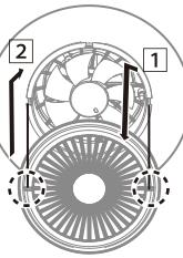
② 前ガードを時計回りに回し、前ガードが外れないようにロックします
