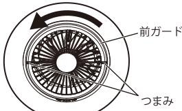
前ガードのつまみを反時計回りに回し、手前に引いて前ガードを取り外します。
