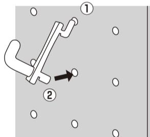
※専用フックは 25mmピッチで厚さ1mmのスチール製パンチングボードで使用できます。
