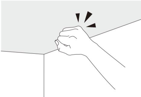
設置前に必ず天井・床の強度を確認ください。天井の強度が弱い際にはサンなどのある位置に取り付けるか、市販のあて板をご利用ください。取り付け・取り外し時の天井・床への損傷については責任を負いかねます。
