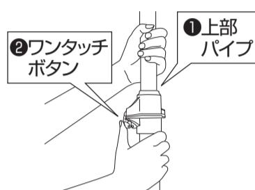
取り外しの際は安全ボルトを抜いて、必ず①上部パイプを持ちながら、②ワンタッチボタンを押してください。
