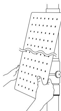
ポールを取り外す際は、必ずスチール有孔ボードを外してから、ポールを取り外してください。ボードを付けたままポールを取り外すと危険です。
