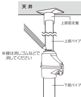
(1) 上部固定盤が軽く天井につく程度に押し上げ、えんぴつで下図のように線を描きます。
