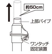
上部パイプを約50センチほど出してから部品を差し込むと組み立てやすくなります。
