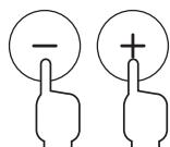
プラスボタンを押すと風量が強くなり、マイナスボタンを押すと風量が弱くなります。風量7段階の切り換えができる、風量に応じて風量ランプの点灯が増減します。
