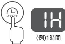
運転中にタイマーボタンを押すと、切タイマーランプが点灯し、切タイマー設定ができます。タイマーボタンを押すたびに切タイマー設定時間がかわり、表示部に設定時間を表示します。表示部の設定時間が点滅から室温表示に変わると、設定完了します。
