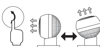
上下首振りボタンを押すと、上下(約75度)に首振り動作し、上下首振りランプが点灯します。再度押すとランプが消灯し、首振りが停止します。
