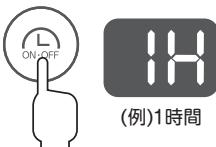
運転停止中にタイマーボタンを押すと、入タイマーランプが点灯し、入タイマー設定ができます。タイマーボタンを押すたびに入タイマー設定時間がかわり、表示部に設定時間を表示します。表示部の設定時間が点滅から点灯に変わると、設定完了します。
