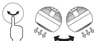
左右首振りボタンを押すと、左右(約75度)に首振り動作し、左右首振りランプが点灯します。再度押すとランプが消灯し、首振りが停止します。
