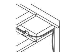
電源コードを固定せずに使用すると、断線やショートを引き起こし、火災や感電、故障の原因になります。
