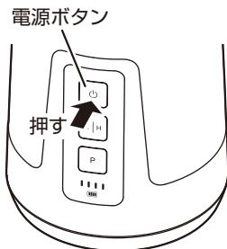
**残量表示** 電池残量に応じて点灯/点滅します。
