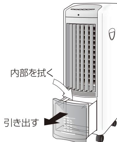
水タンクの水の交換を怠ると、水あかや空気中のホコリによって水位センサーが固まって動かなくなったり、水を循環させるパイプなどが詰り冷風運転ができないことがあります。また、カビやにおいの原因になりますので、水の交換は、こまめに行ってください。
