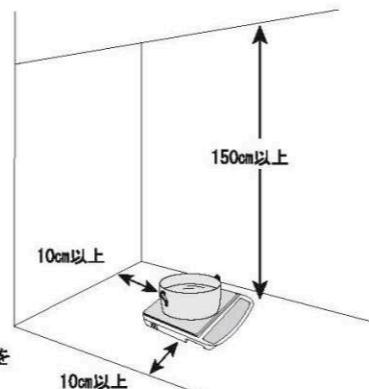
製品を10cm以上壁より離さないと十分な内部冷却が出来ずに安全装置が働く場合がありますのでご注意ください。
