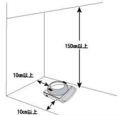
製品を10cm以上壁より離さないと十分な内部冷却が出来ずに安全装置が働く場合がありますのでご注意ください。
