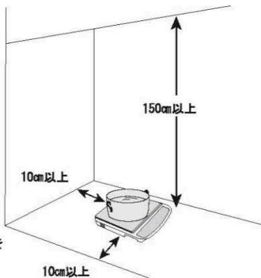
製品を10cm以上壁より離さないと十分な内部冷却が出来ず安全装置が働く場合がありますのでご注意ください。
