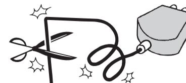
また、重たい物を載せたり、挟み込んだり、加工したりすると、電源コードが破損し、火災・感電の原因となります。
