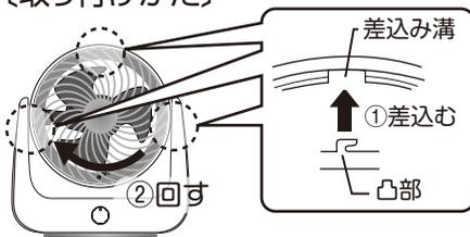
ガードの裏面の凸部(3ヶ所)を本体の端にある溝に差込んでからガードを図の方向に回し、ネジを締める。
