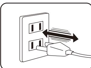
**短寿命** コンセントへの抜き差しが頻繁、また電源プラグを斜めに抜き差しする
