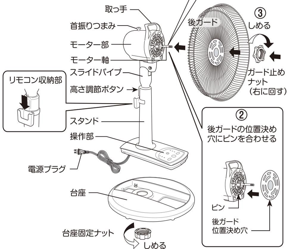
① 電源コードを台座の穴に通し、スタンドの凸部を台座の穴に差し込む
