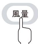
風量ボタンを押すごとに風の強さがかわり、風量に対応したランプが点灯します。
