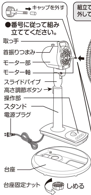
組立て前にモーター軸からナットと保護キャップ、スピナーを外してください。※注意:スピナーは逆ネジになっています。
