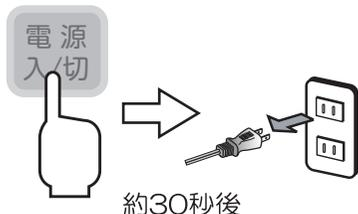
入/切ボタンを押してください。すべてのランプが消えて約30秒間送風運転をしてから停止します。その後、電源プラグをコンセントから抜いてください。
