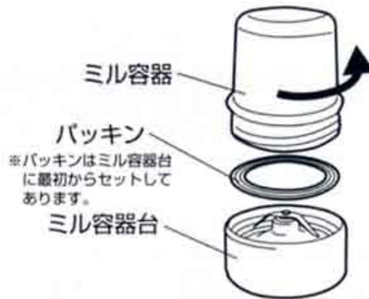
分解する時はミキサーボトル・ミル容器を右（時計回転）に回してください。
