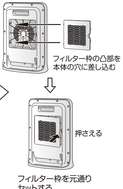
フィルター枠の凸部を本体の穴に差し込む
