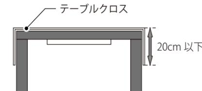
飛び出しを 20cm より大きくしますと、テーブルクロスを巻き込み、火災や故障の原因となります。
