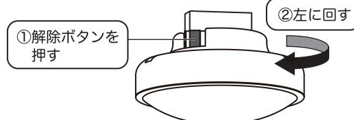
**△** 解除ボタンを確実に押さないまま左に回しますと破損の原因となります。
