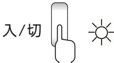
風速ランプが点灯し、再度押すと停止します。
