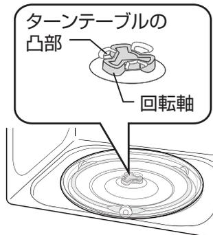
ターンテーブルの凸部を回転軸の形状に合わせます。
