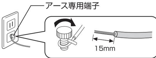
アース線の先端の被覆をむき、アース端子に確実に固定してください。
