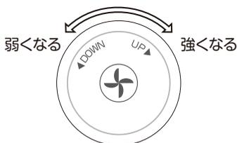
ダイヤルを回すことで風量が5段階に変わり、風量に対応して数字(1~5)を表示します。
