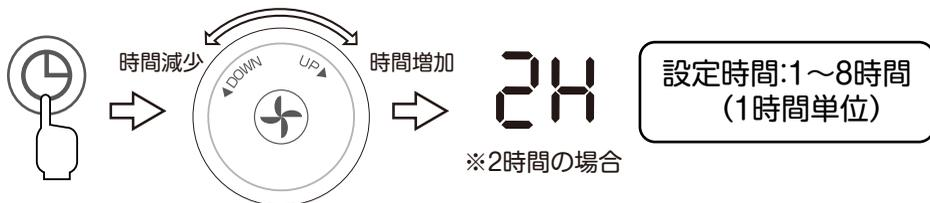
運転中に切タイマーボタンに触れてから、約5秒以内にダイヤルを回して時間を設定します。表示部に時間が表示され、設定が完了すると室温表示にかわります。
