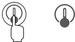
センサー運転ボタンに触れると、温度センサーで感知した室温に応じて、自動的に風量を変えて運転します。このときセンサーボタンが点灯して、表示部に緑色のセンサーマークが表示されます。
