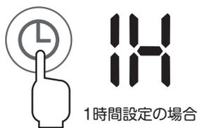
運転中に切タイマーボタンに触れると切タイマーのセットができます。切タイマーボタンに触れるたびに設定時間がかわり、表示部に設定時間を表示します。また、ランプ「🕒」が点灯します。
