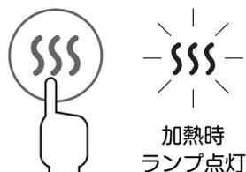
ヒーターボタンに触れると、表示部にランプ「SSS」が点灯し、トレイ内の水を加熱します。再度触れるとランプが消灯し、加熱を停止します。
