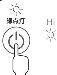
電源ボタンに触れると、加湿量強「Hi」で加湿運転が始まります。このとき電源ランプが緑点灯して、加湿量ランプ「Hi」が点灯します。
