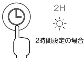
運転中に切タイマーボタンに触れると切タイマーのセットができます。切タイマーボタンに触れるたびに設定時間がかわり、設定時間に対応したランプが点灯します。
