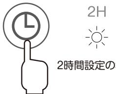
運転中に切タイマー ボタンに触れると切タイマーのセットができます。切タイマー ボタンに触れるたびに設定時間がかわり、設定時間に対応したランプが点灯します。
