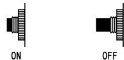
直流サーキットブレーカー
