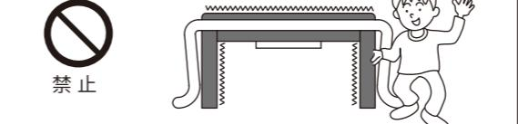
本体や脚の破損、ボルトが欠落し、火災や感電、やけど、故障の原因になります。
