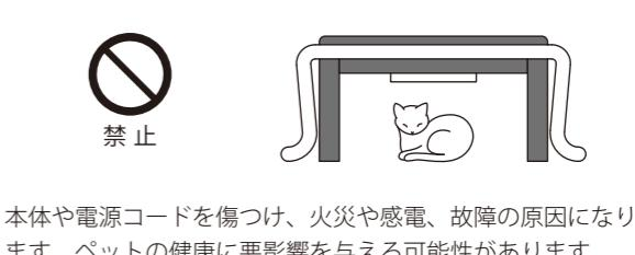
電源コード、電源プラグ、器具用プラグ、電子コントローラーが破損するようなことはしない。
