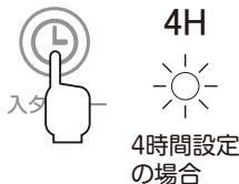
運転前に、入タイマー ボタンに触れるときセッティングされ、触れるごとに設定時間がかわります。設定時間に対応したランプが約2秒間点滅して、点灯に変わると設定完了です。
