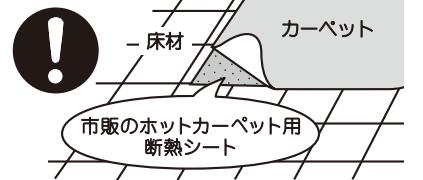
断熱をしないと、床材の変色・変形・割れ・すき間の原因になります。
