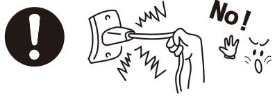
コードを引っ張ると、コードが破損し、感電・ショート・火災の原因になります。
